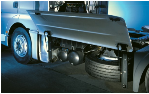
Fig. 8 Colocación depósitos de aire comprimido y rueda de repuesto
