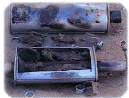
Fig. 10 Fusión del interior del catalizador
