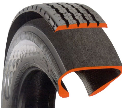
Fig. 17 Aplicación de una nueva banda
