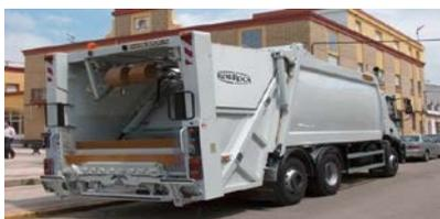
El protector lateral no aumentará la anchura total del vehículo y la parte principal de su superficie externa no se adentrará más de 12 centímetros con respecto al plano más externo del vehículo (su anchura máxima).
