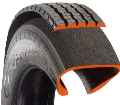
Fig. 17 Aplicación de una nueva banda
