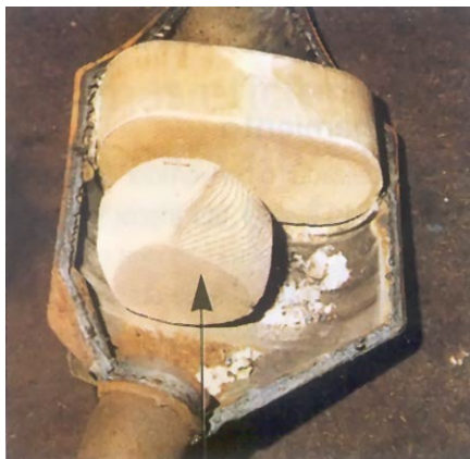
Fig. 11 Desgaste y rotura del catalizador
